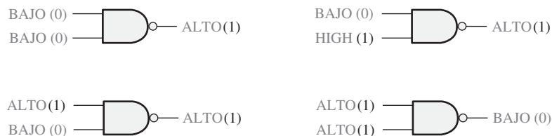
FIGURA 3.26 Funcionamiento de la puerta NAND de 2 entradas.
