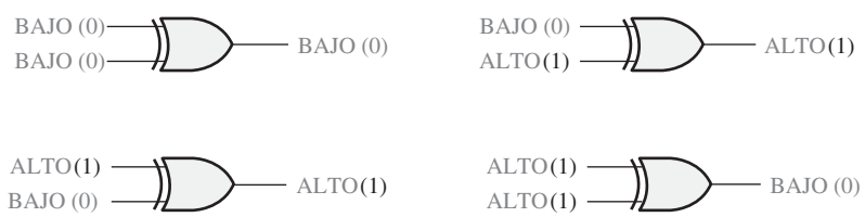
FIGURA 3.42 Todos los niveles lógicos posibles para una puerta OR–exclusiva.
