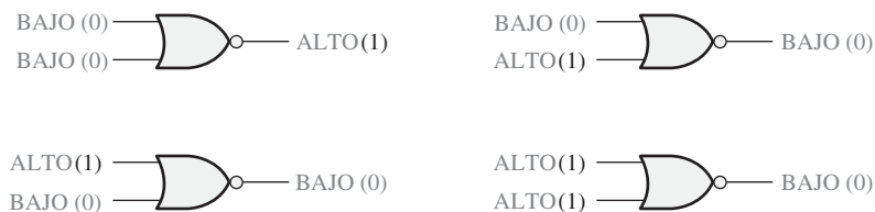
FIGURA 3.34 Funcionamiento de la puerta NOR de 2 entradas.
