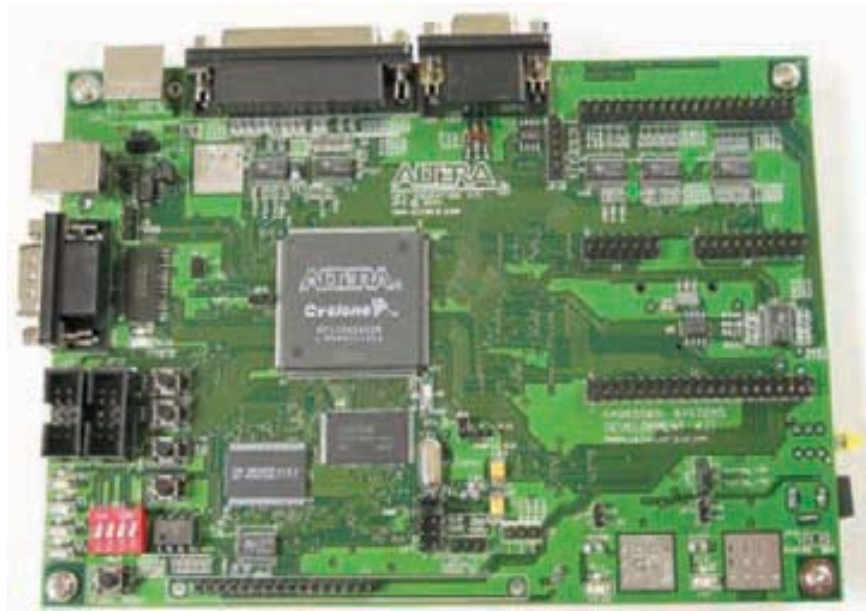
FIGURA P-1 La tarjeta de desarrollo UP3 de Altera.
