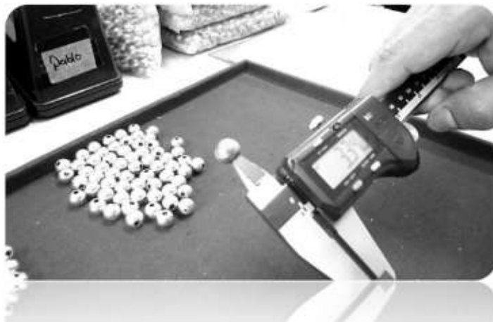
Ejemplo de inspección dimensional mediante calibre/pie de rey
