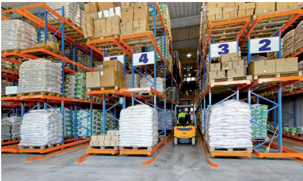
Fig. 5.8. La codificación de las áreas del almacén debe estar bien señalizada. En este caso, el sistema de codificación es por estanterías.
