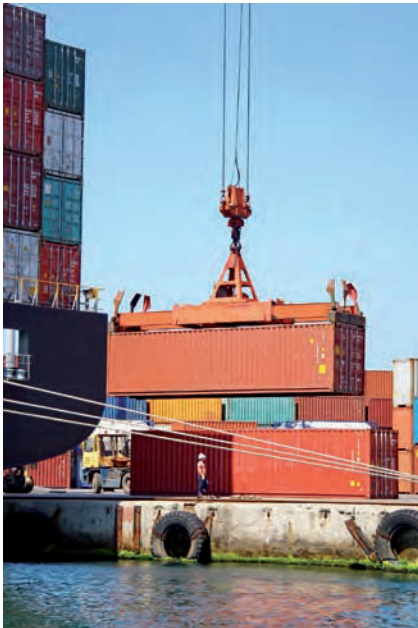
Fig. 6.5. Los contenedores permiten transportar la carga de un barco a un vagón de tren o a un camión con la mínima manipulación en puerto.
